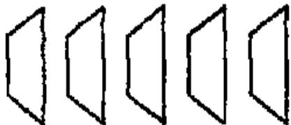
Нарисуйте 5—6 одинаковых трапеций в указанном взаиморасположении. Размеры оснований трапеций удобно взять 10 и 20 мм, расстояние между основаниями — 10 мм, а расстояние между трапециями — 5 мм.
